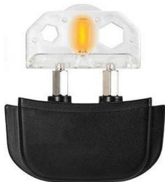
Touchez le fil sur la face inférieure de l'ampoule témoin contre les montants métalliques. Appuyez sur le bouton "Y" pour allumer la LED.
