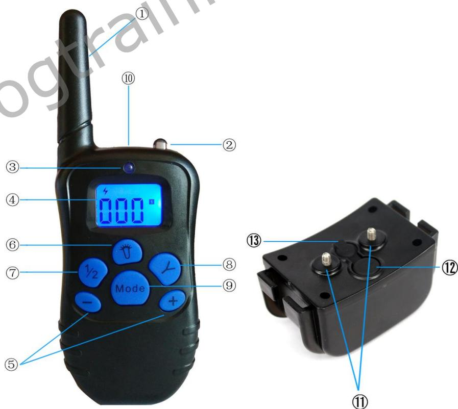
1. **Antenne:** Transmet le signal de l'émetteur au collier du récepteur.
